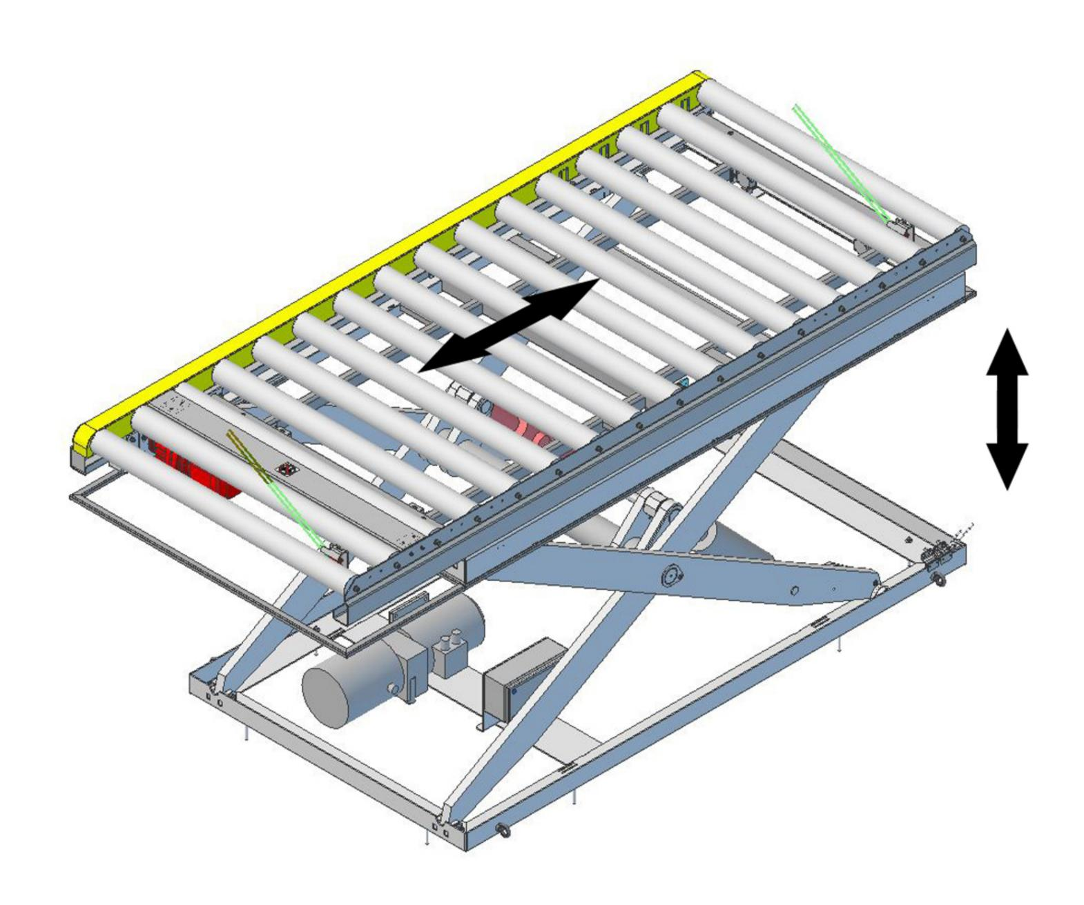
Hebebühnen sind hubfähige Maschinen, die mit verschiedenen Förderelementen ausgestattet werden können. So können Holzstapel und einzelne Platten horizontal und vertikal transportiert werden. Die Hebebühnen heben bzw. senken das Arbeitsmaterial auf das Niveau der nächsten Produktionsebene. Sie kommen zum Einsatz bei der Lagerung und Sortierung und werden sowohl als manuelle Einzelstation oder als Teil eines automatisierten Systems eingesetzt.
